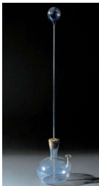
Figura 2. Foto de uma réplica do Termoscópio utilizado por Galileu.
